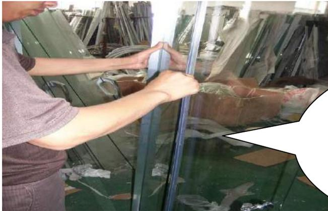
Установите магнитный уплотнитель на дверь и несколько раз откройте\закройте дверь для более плотного контакта.
