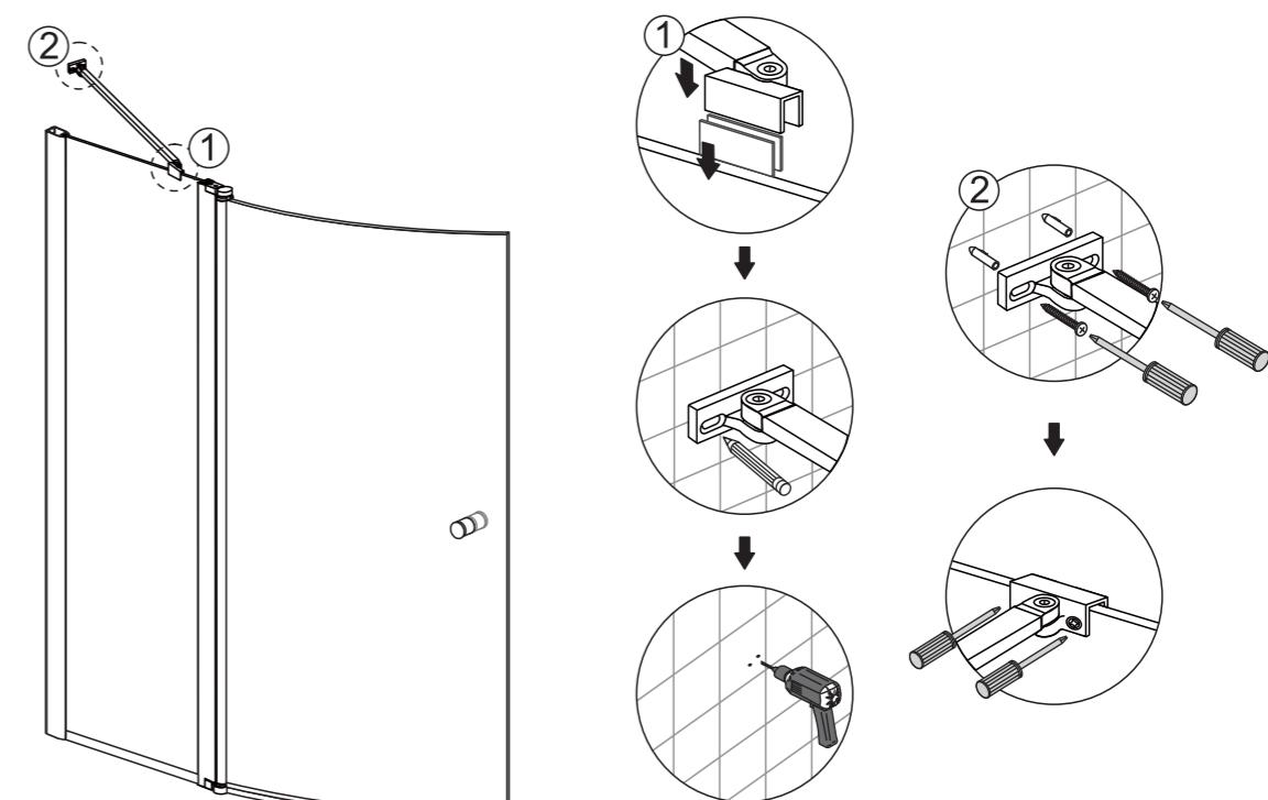
⚠ Необходимо вертикально установить стенные профили, настроить их по уровню. Колесики должны быть отрегулированы по плоскости двери и должны обеспечивать плавный ход
