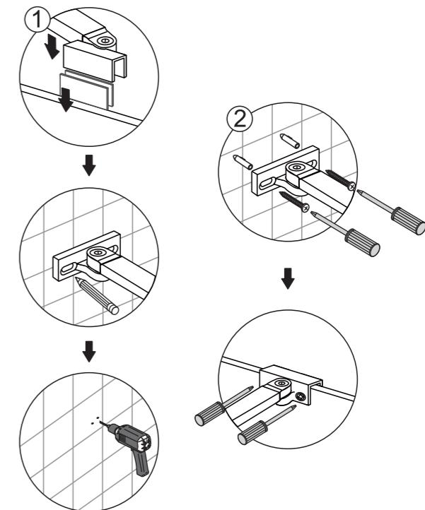
⚠ Необходимо вертикально установить стенные профили, настроить их по уровню. Колесики должны быть отрегулированы по площади двери и должны обеспечивать плавный ход
