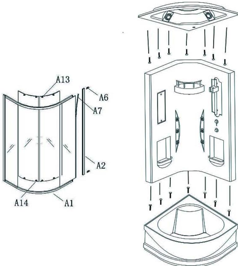
При монтаже стекол кабины, будьте внимательны! Не ставьте стекла на кафельный пол без защитного картона, избегайте ударов и падения стекол на угол!
