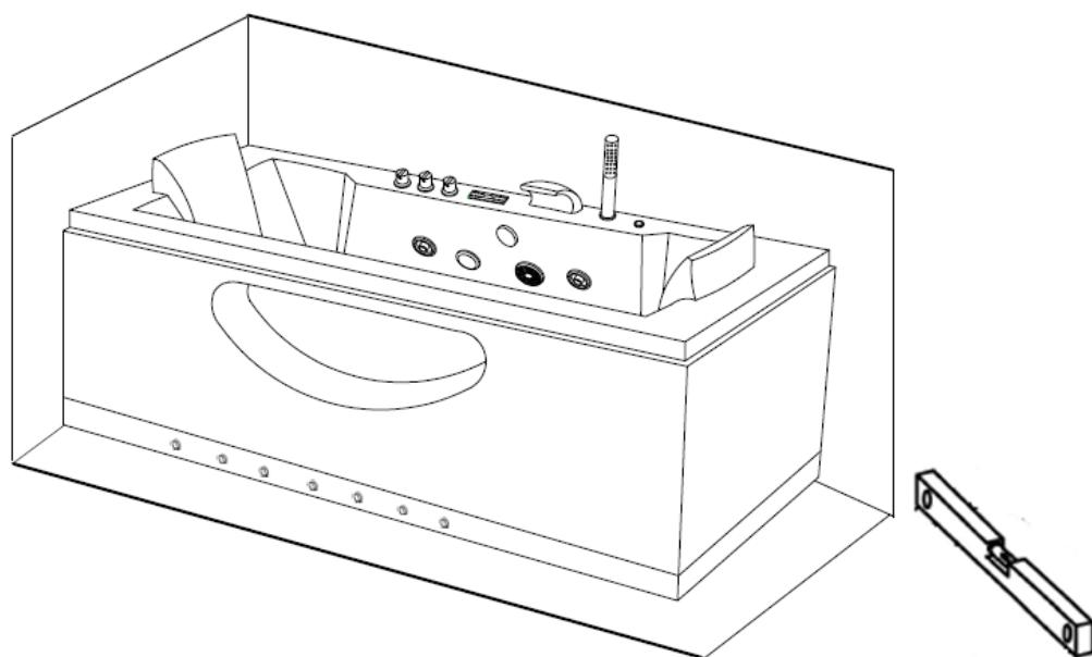
**Рекомендуется использовать герметик между ванной и стеной, чтобы вода не попадала на пол.**
