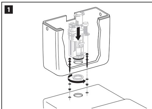
1 - Installare sulla cassetta il kit di fissaggio in dotazione prima del meccanismo, frapporre tra il vaso e la cassetta l'apposita guarnizione prima di fissarla.
